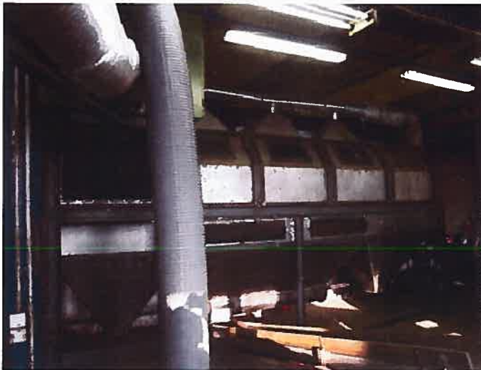
Bild 3: Ansicht des Fraktionierers mit Auffangtrichtern und Staubabsaugung
