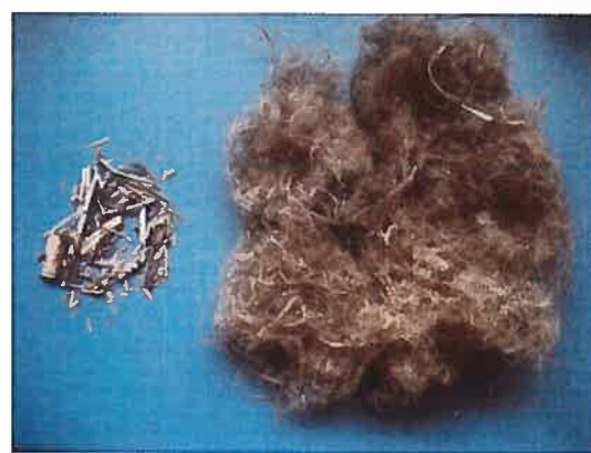
Bild 8: Schäben in der Faserfraktion (Versuch 3, ohne Hammermühle)
