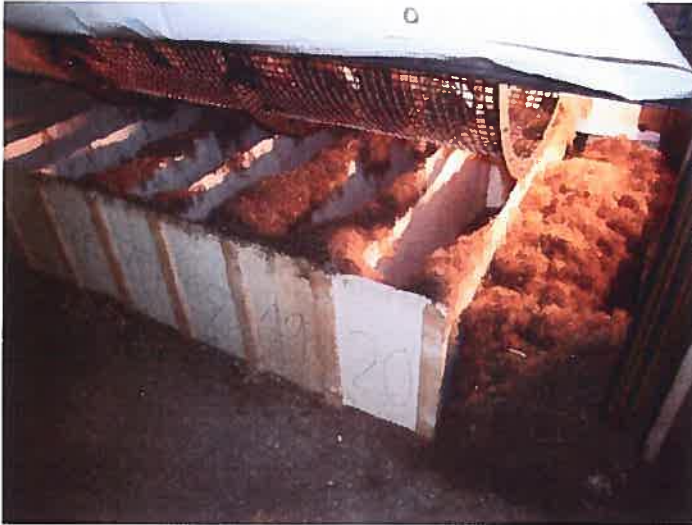
Bild 2: Auffangkästen unter den Sieben und Faserfraktion am Ende
