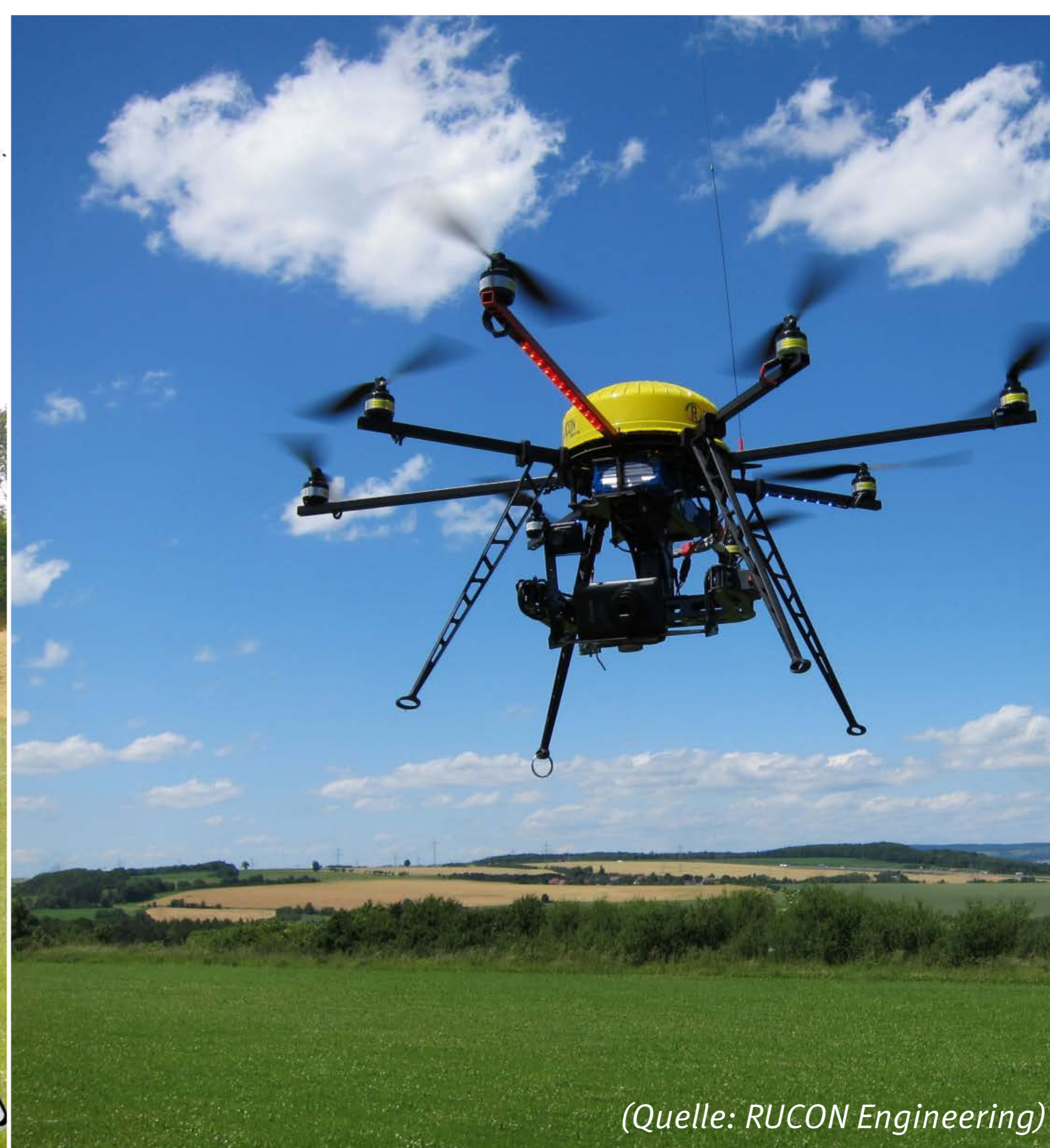
Abb. 2: Oktokopter mit Wärmebildkamera
