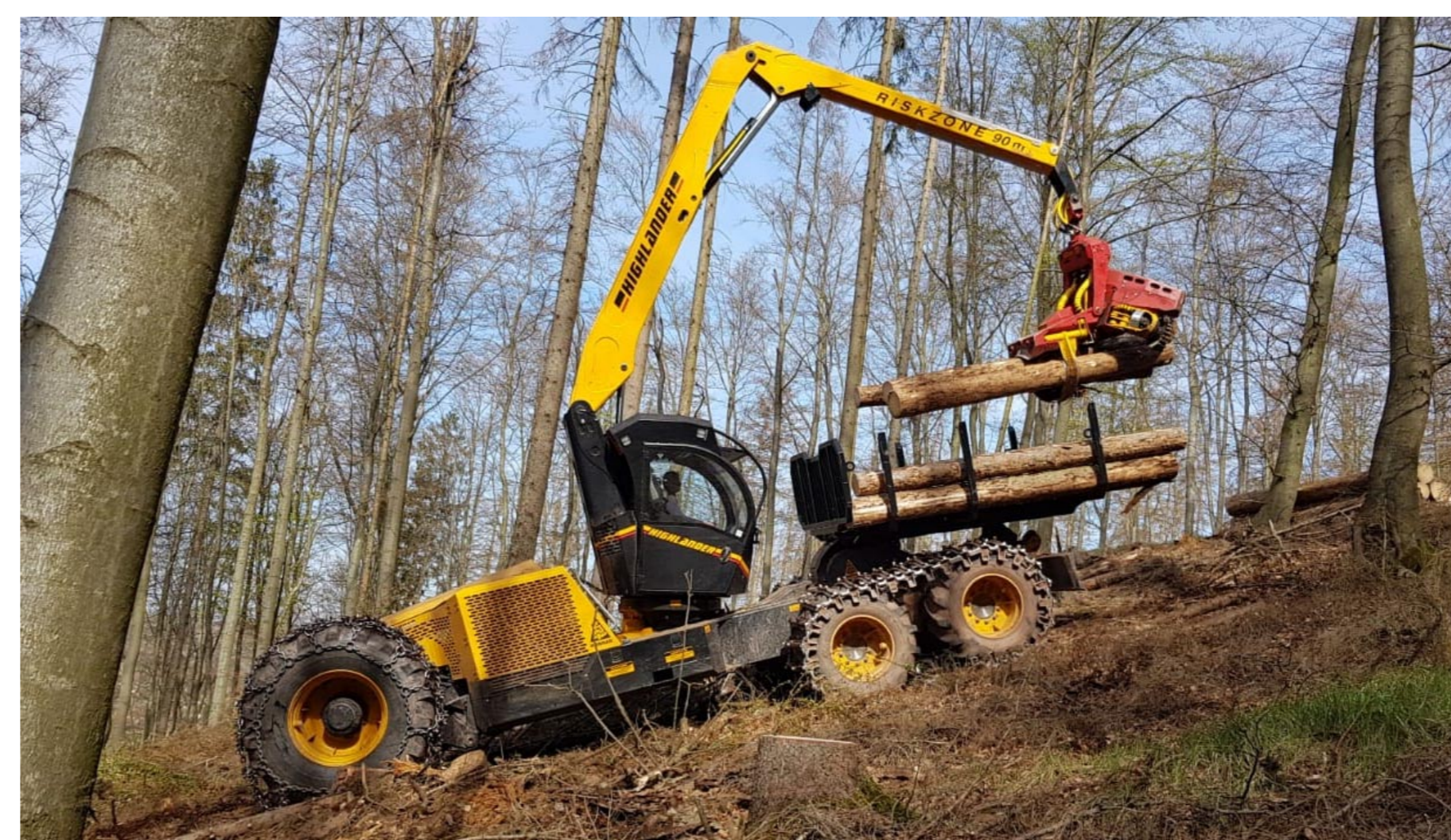
Harvarder Highlander mit Rungenkorb und Traktionsseilwinde © Prof. Erik Findeisen
