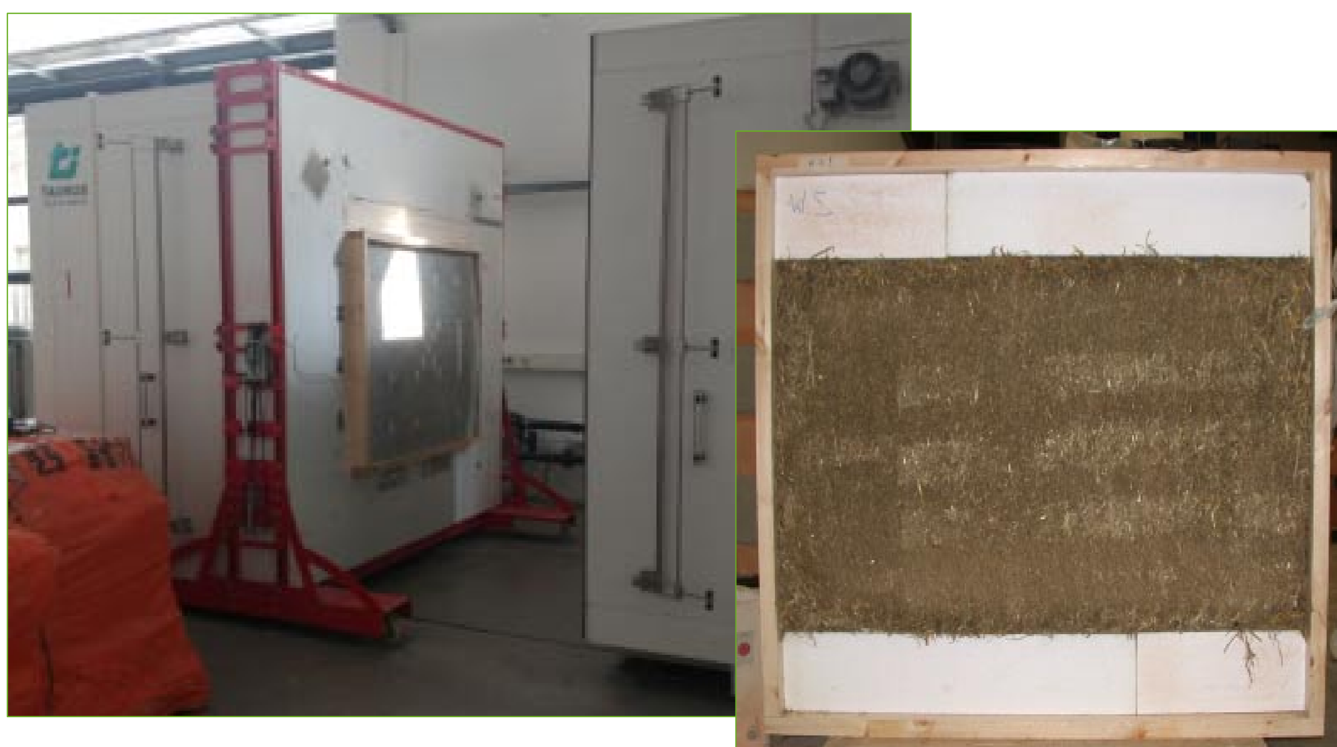
Wärmeleitfähigkeitsmessung: Probekörper mit Maske im Wandprüfstand (links) und Herstellung des Probekörpers (rechts) Foto: Helbig, MFPA
