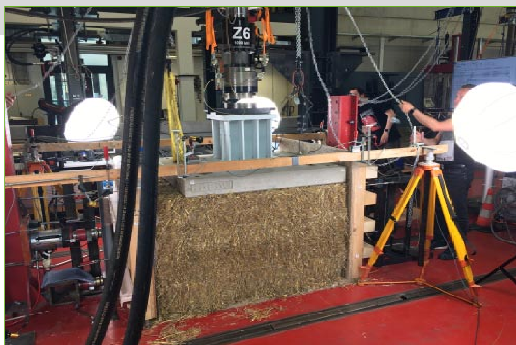
Strohballen im mechanischen Prüfstand vor dem Kurzzeit-Belastungsversuch : Die Lastverteilungskonstruktion wird auf dem Ballen abgesetzt. Foto: Taube/BUW
