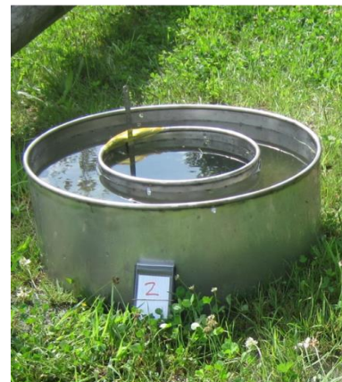
Sickerversuch mit Doppelring-Infiltrometer
