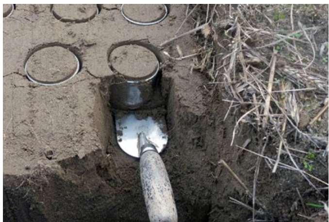
Probenahme mit Stechzylindern (Foto: J. Zimmer)
