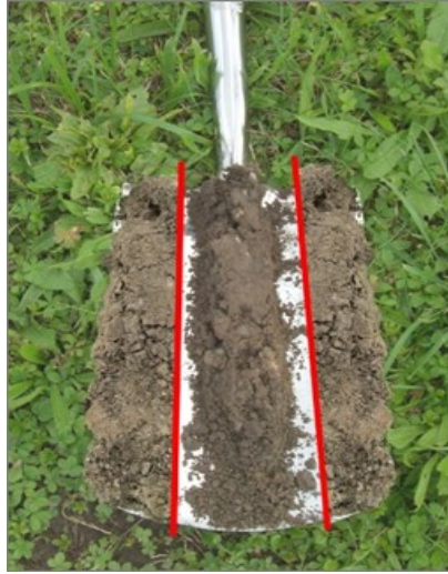
Einzelprobe vom abgestochenen Bodensegment
